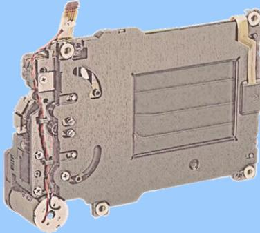
L'obturateur est le système permettant de protéger le capteur durant la majorité du temps. Mais c'est aussi le système qui permet de réaliser la durée d'exposition du capteur durant la prise de vue.
